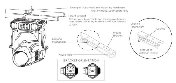
FIGURE 1. INSTALLING BRACKETS ON LUMINAIRE ENCLOSURE
