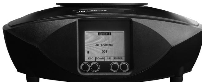
Besondere Bereiche können nur über eine bestimmte Tastenkombination aufgerufen werden. Dabei wird die Taste "ENTER" gedrückt, gehalten und dann zusätzlich mit der gegenüberliegenden Taste "ESC" der Zugang zum Menü freigeschaltet. Das Verlassen der Funktion erfolgt dann in umgekehrter Reihenfolge.
