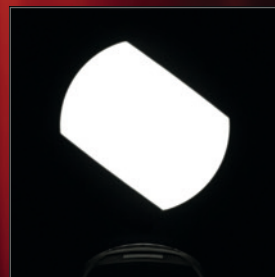
Alle Blenden komplett schließend und exakt parallel positionierbar
