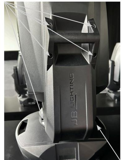
Im nächsten Schritt werden die Drehteile für die Tilt-Begrenzung eingebaut. Hierzu mit einer Pinzette/Spitzzange das Drehteil zwischen Kopf und Arm einführen von hinten in das entsprechende Loch setzen und mit dem Schraubendreher Torx TX20 die Schraube andrehen. Dieses Vorgehen für den 2. Anschlag entsprechend wiederholen. Um nun z.B. eine Bewegung des Kopfes von  $-66^\circ$  bis  $66^\circ$  zuzulassen, müssen die Anschläge für Anschlag 1 ins Loch 06 und für Anschlag 2 ins Loch 23.
