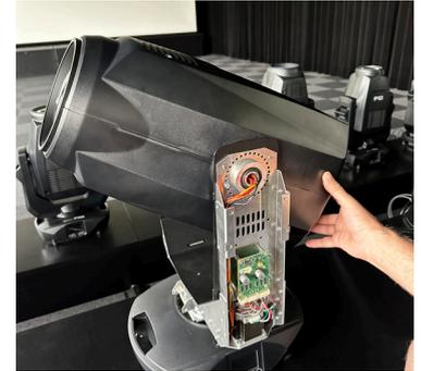
Jetzt erfolgt der Einbau der Teile für die PAN-Begrenzung. Hierzu die Lochsteine entsprechend des gewünschten Winkels auf die vorgesehenen Einschraubblöcher legen und jeweils mit den beiden Schrauben TX10 fixieren (siehe Bilder). Übersicht der Winkel siehe folgende Seite.
