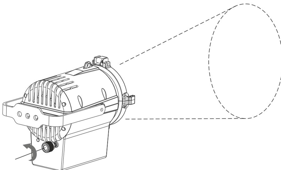
Wird der Zoom-Regler des Gerätes im Uhrzeigersinn gedreht, verkleinert sich der Lichtkegel des Gerätes.
