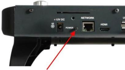
Um die Konsole einzuschalten, schließen Sie einfach das mitgelieferte 12-V-Netzteil an. Wenn die Konsole über die Software heruntergefahren wurde, drücken Sie den Netzschalter auf der Rückseite. Nach einigen Sekunden wird der Bildschirm aktiviert und das Betriebssystem wird geladen.
