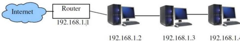
Die Computer verwenden eine Subnetzmaske von 255.255.255.0. Dies gibt an, welcher Bereich von IP-Adressen sich im lokalen Netzwerk befindet. Im obigen Beispiel gibt 255.255.255.0 einen Bereich von 192.168.1.0 bis 192.168.1.255 an, dh insgesamt 256 Adressen.
