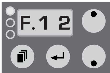
Einstellung der Nebelzeit (Fogtime) in Sekunden (1-99)
