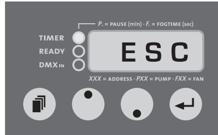
Escape zum Wechseln ins Standard-Menü mit Enter-Taste
